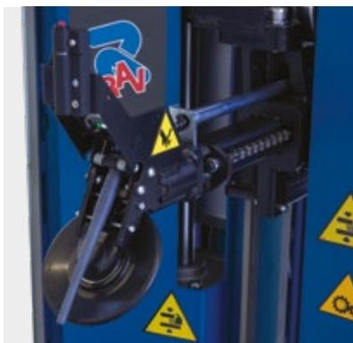
Sensor mit automatischer Aktivierung der Rollenvorschubfunktion für präzises und reifenschonendes Abdrücken.
